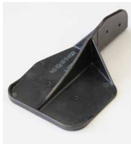
Bild 1. Eine Halterung für eine Tür ist das erste Flugzeug-Primärstrukturbauteil aus Victrex PEEK und kommt im Airbus A350 XWB zum Einsatz (© Airbus Helicopters)
