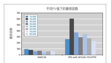
在不同的 PV值和运行温度(1200C至2400C) 条件下,与激光打印机配件常用材料 30%玻璃纤维 +15% PTFE填充的聚苯硫醚(PPS) 相比, VICTREX PEEK 450FC30的耐磨性能都表现卓越.
