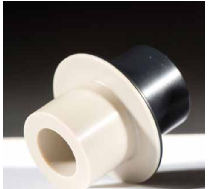
레이저 용접을 통해 자연색과 검은색의 빅트렉스 PEEK 부품의 정확하게 결합시킬 수 있습니다.
