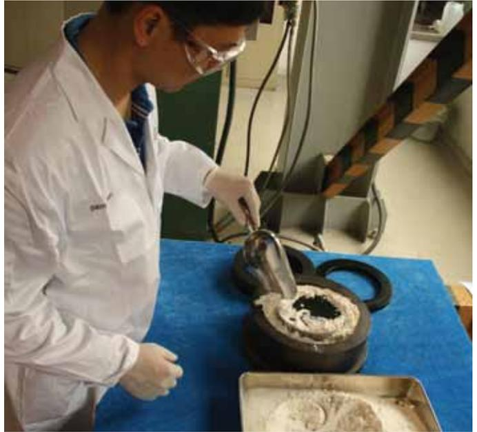
適正量のビクトレックス PEEK パウダーを清浄な金型内へ丁寧に充填することがポイント
