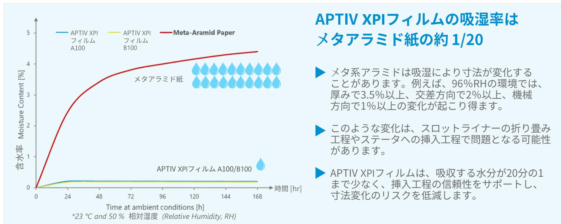
“ Equipmake社は、自動車および航空宇宙産業向けに最先端の高性能モータを開発しており、冷却システムの改善に重点を置いています。今回、スロットライナーの材料にビクトレックス社のAPTIV XPI™フィルムを採用することで、サーマルマネジメントの向上を実現しました。”
