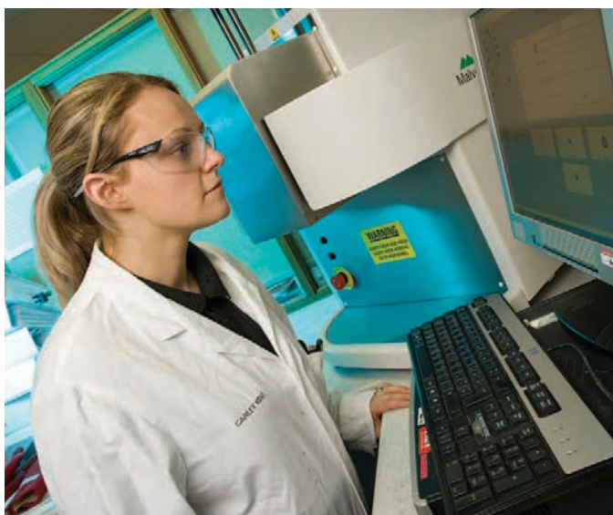
Des équipements de test pointus sont utilisés pour mesurer la viscosité de cisaillement.
