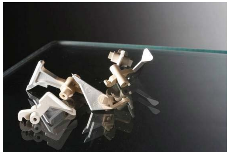
VICTREX™ HT™ Polymer ersetzt einen fluorpolymerbeschichteten Splitfingerring aus Metall in Druckern, wodurch Nachbearbeitungsschritte eliminiert wurden. Der Splitfingerring aus HT Polymer hält den hohen tribologischen Anforderungen und Temperaturen stand.
